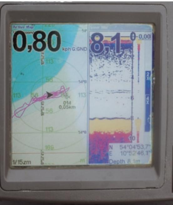
4. Das Echolot mit integriertem GPS zeigt Wassertiefe und Position exakt an. Damit wissen wir genau, wie tief die Pose eingestellt werden muss.
